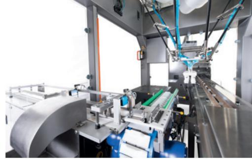
Системы **MRS - Robovision** представляют собой ячейки, оснащенные высокоскоростными роботами, управляемыми искусственным зрением, предназначенные для ситуаций, когда поступающий навалом продукт должен быть упорядоченно размещен внутри упаковок.
